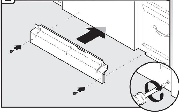
Maintenir les deux panneaux ensemble et les placer contre les pieds du lave-vaisselle. Réinstaller les vis à travers les trous du panneau d'accès et les fentes du panneau inférieur à l'aide d'un tournevis Phillips ou tournevis de 1/4".
